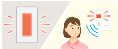
代表廊下灯が点灯します。呼出音(アラーム)が鳴り、呼出表示灯が点滅します
